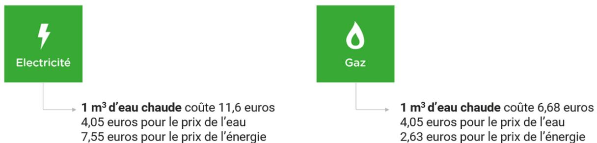
**Figure 1 : Répartition du coût d'un mètre cube d'eau chaude entre eau et énergie en fonction du type d'énergie utilisée**
